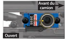
**Différentiel verrouillé :** Allumez le récepteur et le transmetteur. Mettez le commutateur T-Lock à la position la plus avancée pour verrouiller le différentiel arrière. Confirmez que l'arbre de sortie du servo tourne dans le sens contraire des aiguilles d'une montre pour pivoter le palonnier de servo à la position montrée.
