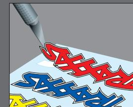
Pour appliquer les décalques, mettez une extrémité sur la surface tout en en tenant l'autre entre les doigts, ensuite lissez graduellement le décalque du doigt sur la surface. Ceci empêchera la formation de bulles d'air. Si vous mettez les deux extrémités du décalque sur la surface en même temps et essayez ensuite de le lisser, il y aura des bulles d'air. Regardez les photos sur la boîte pour apprendre la méthode typique d'application des décalques.
