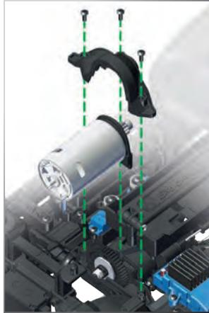
Pour régler l'engrènement, utilisez le diagramme à gauche pour identifier les positions des vis sur le plateau moteur (A - H) qui correspondent à la dimension du pignon moteur (9-T - 22-T) et du pignon droit (39-T ou 45-T) choisis. Retirez les deux vis du moteur/plateau moteur et réinstallez-les à la position correspondante. Réinstallez l'ensemble moteur/plateau moteur dans le châssis.
