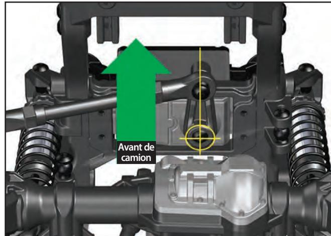
Si vous utilisez des servos du marché des pièces de rechange, il est important d'utiliser les palonniers de servo conçus pour le TRX-4. Les palonniers de servo doivent mesurer 22 mm du trou de montage de la tringlerie de direction au trou de montage du servo.
