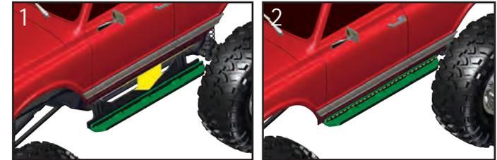
2. Appuyez sur la carrosserie au niveau de chaque loquet jusqu'à ce que les loquets soient en place.
